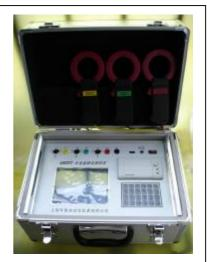
HSDZC-B 电能综合测试仪是本公司专业技术人员为填补变频设备检测难,经多年精心研制而开发的一台变频检测仪表。
